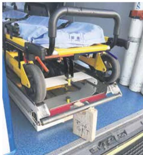
Bancada rota y sujeta con un taco de madera.
